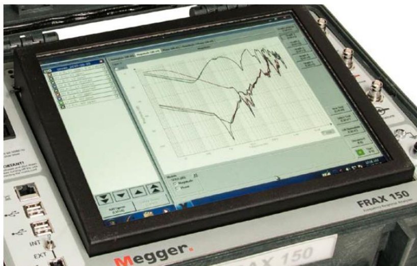
Analizator FRAX 150 wyposażony jest ekran dotykowy o przekątnej 12 cali
