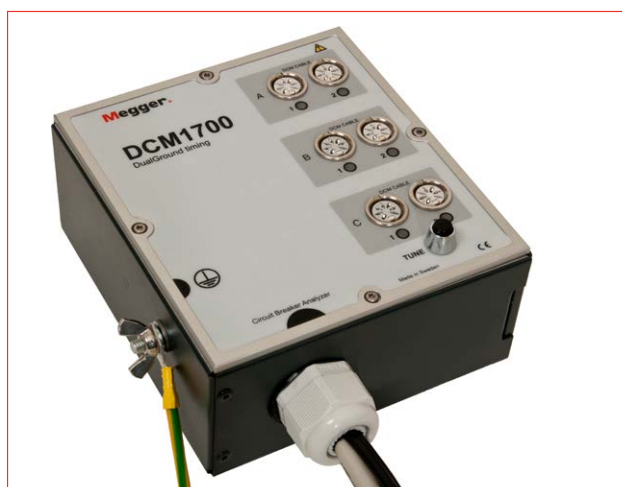
DCM1700, används för tidmätning med DualGround™ metoden. Säker provning med båda sidor jordade..
