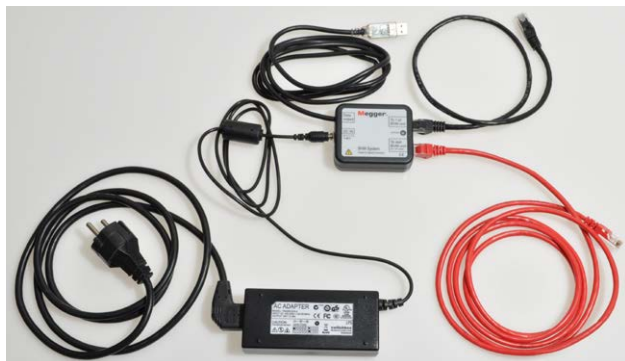
Övriga delar av BVM-systemet: Växelströmsadapter, anslutningsbox för ström och signal samt kablar.
