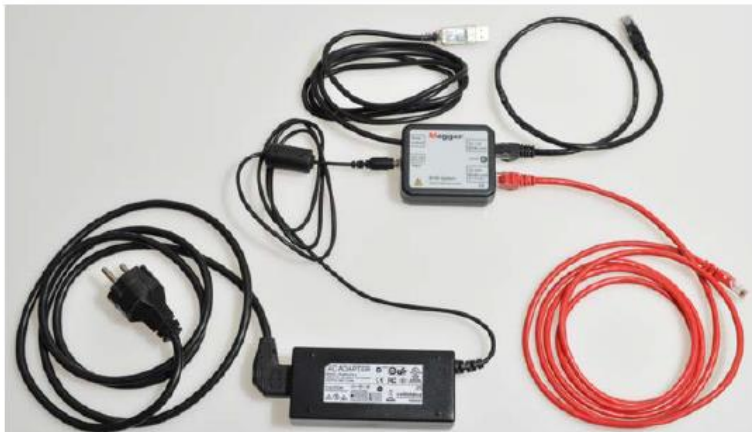
Inne elementy wyposażenia systemu BVM: zasilacz sieciowy, moduł zasilania i komunikacji, kable
