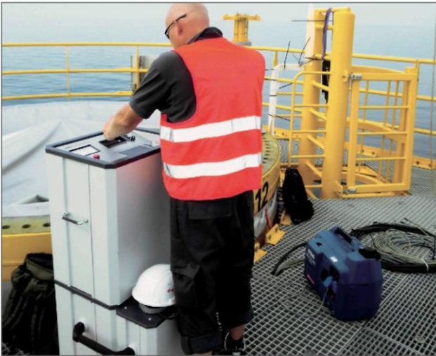
VLF CR-60 kV podczas prac diagnostycznych na farmie wiatrowej „Baltic 1” (Morze Bałtyckie).
