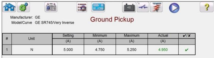
Figura 121. Ejemplo de medida de corriente mínima de conexión a tierra
