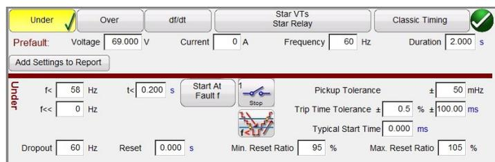
Figura 210. Configuración de medida de relés de subfrecuencia
