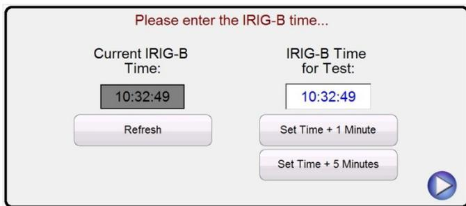
Figura 246. Configuración del tiempo de activación de IRIG-B
