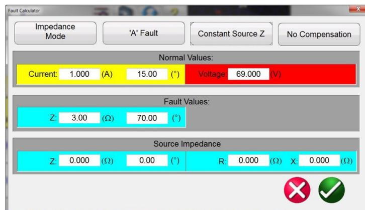
Figura 66. Modo de impedancia, impedancia de fuente constante
