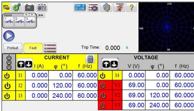
Figura 7. Canal de tensión convertido a corriente
