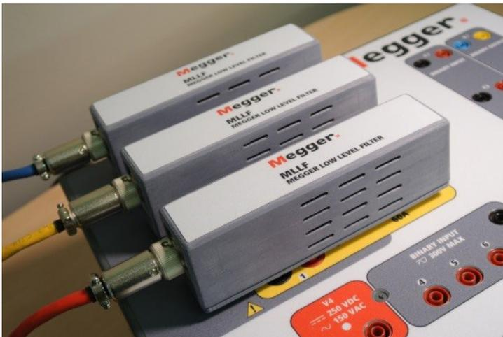
Figura 15. Módulos de filtro de bajo nivel MLLF de Megger
