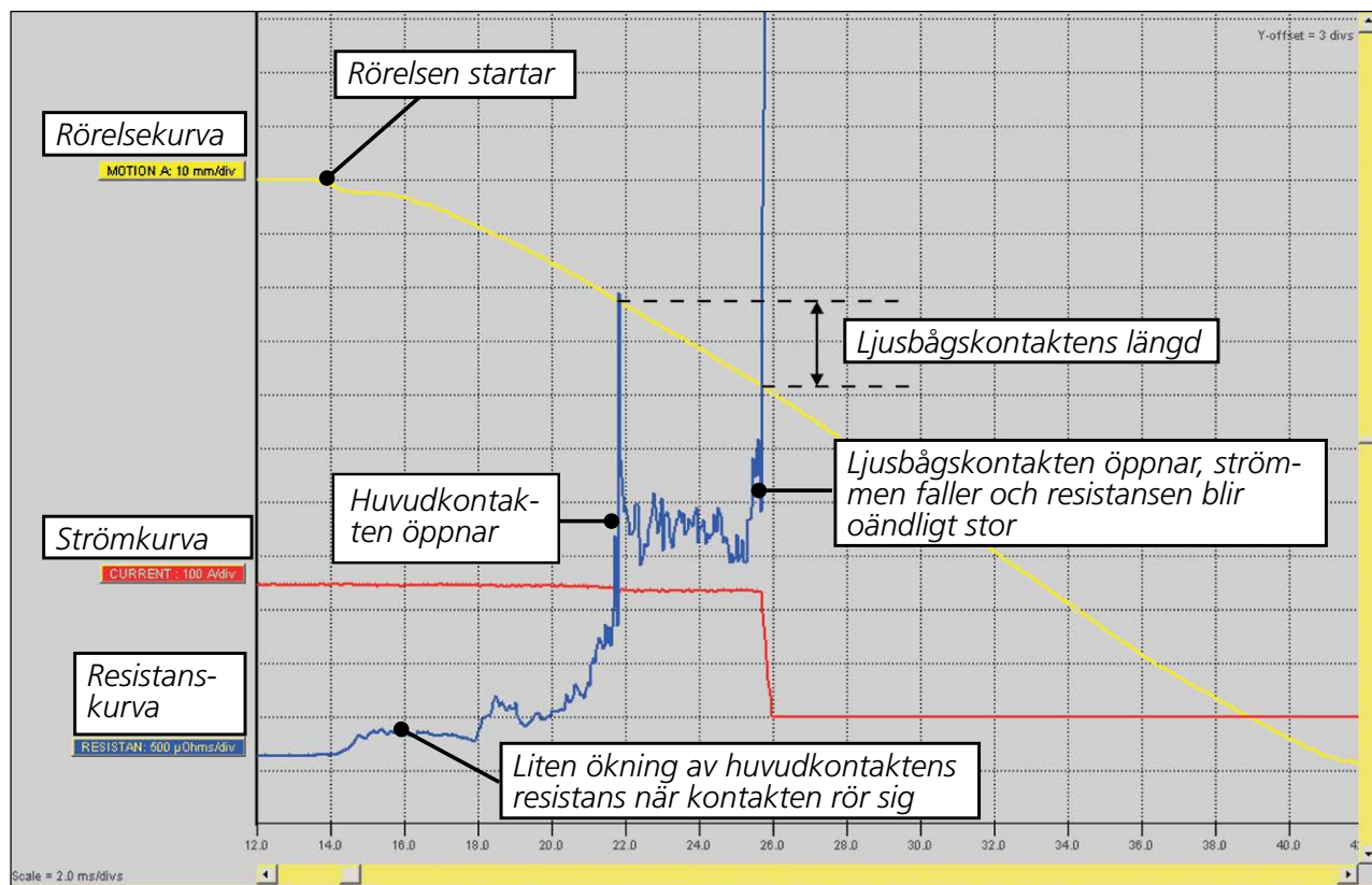
Figur 9.1 Tolkning av DRM-mätning för utvärdering av ljusbågskontaktens längd.
