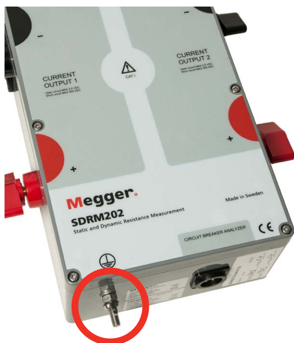
Figur 1.1 Anslutning för skyddsjordsledare
