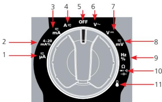
Gire el interruptor para seleccionar una función de medición.
