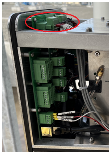
Abbildung 11: Lage der Leistungsrelais
