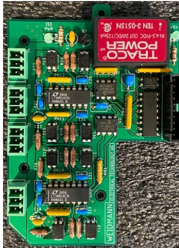
Figure 14 : Module de sortie analogique (1015-315)
