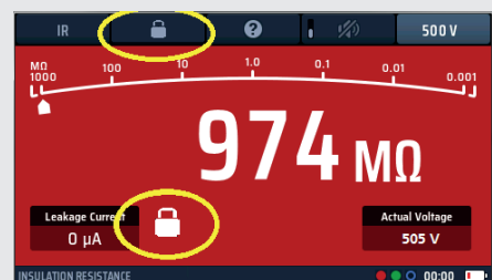
Abb. 23: Dauerhafte Fixierung der Isolationsprüfung
