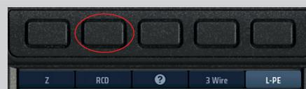
5. Pulse varias veces la tecla de acceso directo 4 para seleccionar la medición de 2-wire (2 hilos) o 3-wire (3 hilos). En el ejemplo (de la derecha) se emplea una conexión de 3 hilos.
