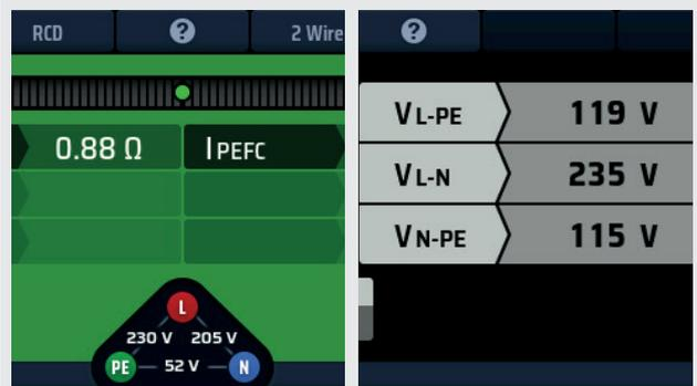
Fig. 7: Voltajes flotantes en medidas de impedancia de bucle y voltaje.
