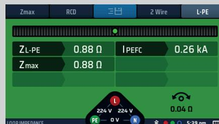
11. Vuelva a conectar el equipo en el siguiente punto en el que desee medir el valor de Zmax. Si está activado AUTO START (Inicio automático) en la configuración pulse el botón de medir ANTES de conectar los cables de medida.
