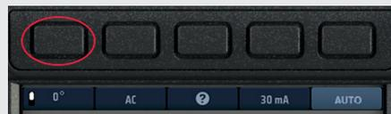
4. Pulse repetidamente la tecla de acceso directo 2 hasta que se indique el tipo de RCD en el que vaya a efectuar la medición.
