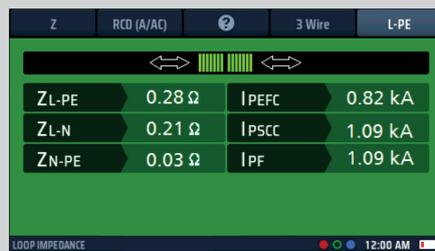
**NOTA:** Las opciones de 2 hilos y 3 hilos se pueden usar para medir la impedancia de bucle en un circuito protegido por un RCD Tipo B de 30 mA. Si el circuito contiene un RCD de 6 mA que protege un RCD Tipo A de 30 mA, se necesitarán 3 conexiones y se debe seleccionar la configuración RCD EV.
