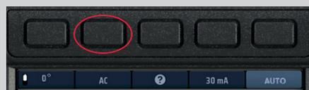
5. Pulse repetidamente la tecla de acceso directo 4 hasta que se indique la corriente nominal del RCD en el que vaya a efectuar la medición.
