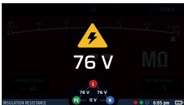
**Fig. 11:** Advertencia de circuito con tensión en el aislamiento
