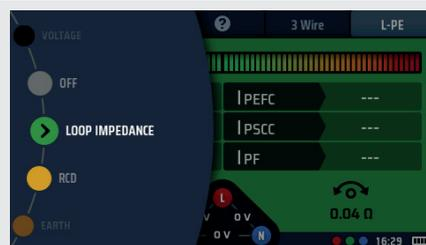
2. Para una medida de tres hilos, conecte el cable de medida L en la toma roja, el cable de medida PE en la toma verde y el cable de medida N en la toma azul.
