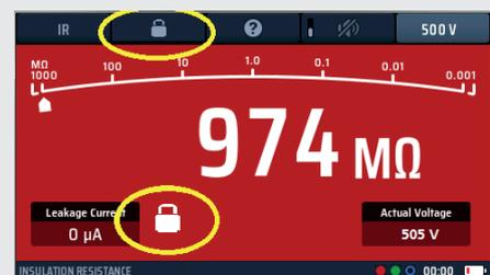
**Fig. 23:** Bloqueo de medida de aislamiento
