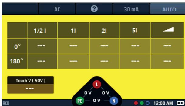
Fig. 45: Ejemplo de pantalla de inicio de medida automática de RCD
