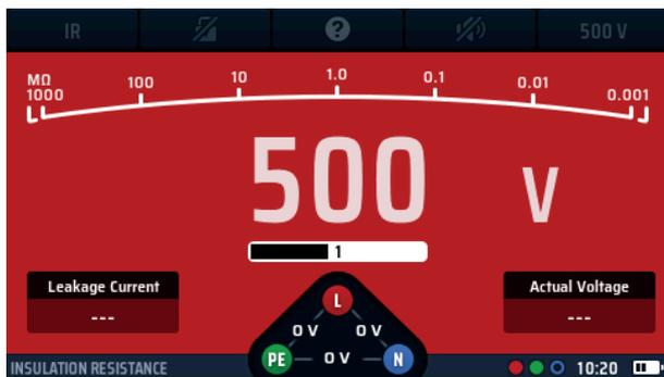
Fig. 19: Temporizador de inicio de resistencia de aislamiento (IR)
