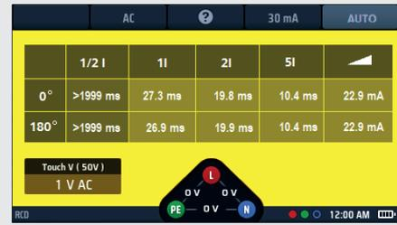
Fig. 46: Progreso del resultado de la medida AUTO (Automática) de RCD
