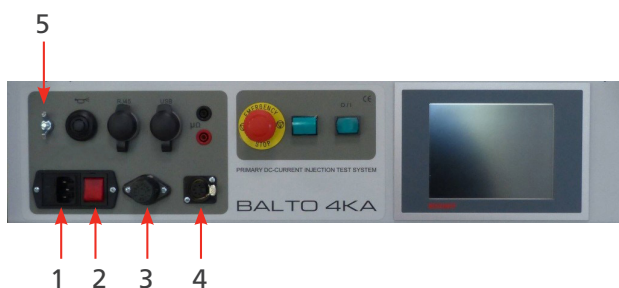
Abb. 15: Versorgung, Sicherungen und Ladeanschluss
