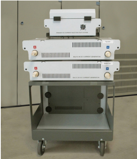
Abb. 32: BALTO Modularsystem mit nur zwei Steckplätzen.
