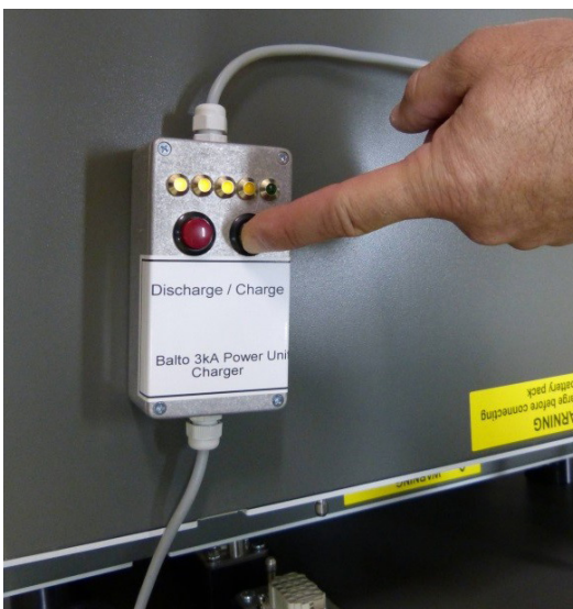
Abb. 27: Laden eines Gleichstromgenerators.
