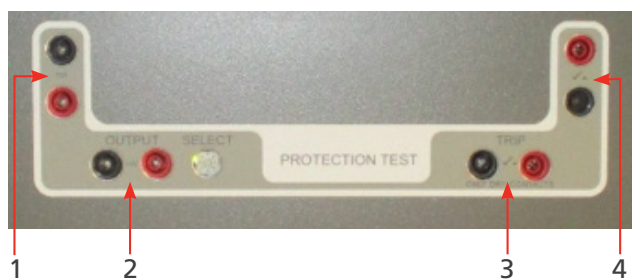
Abb. 16: Schnittstelle für DC-Schutzrelais
