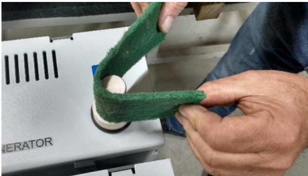
Abb. 51: Reinigen des Steckverbinders.
