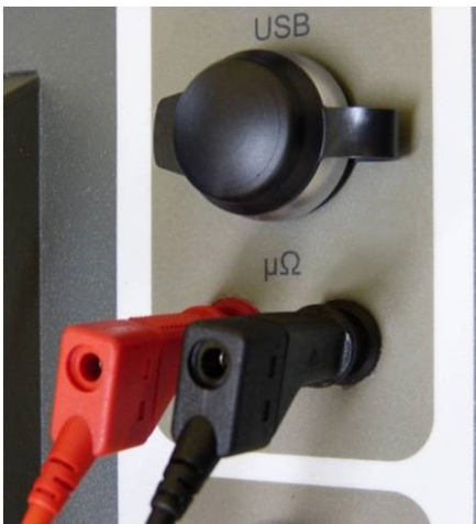
Abb. 37: Bedienfeld: \mu\text{Ohm} -Messanschluss.
