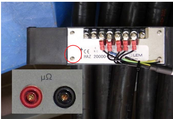
Abb. 47: Sensor zur Kalibrierung.
