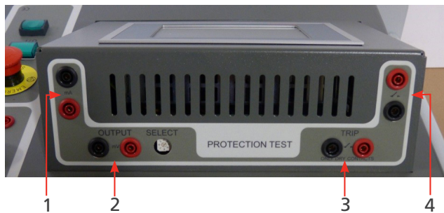
Abb. 8: Steuergerät: Schnittstelle DC-Schutzrelais.
