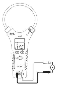
**REMARQUE**: Lors d'une mesure de continuité, l'avertisseur sonore intégré retentit lorsque la résistance mesurée est inférieure à 20  $\Omega$  et s'éteint lorsque la résistance mesurée est supérieure à 200  $\Omega$ . Entre 20  $\Omega$  et 200  $\Omega$ , l'avertisseur sonore peut continuer à retentir.
