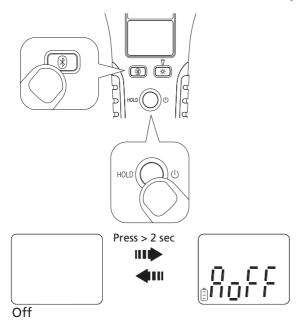
Pour désactiver la mise hors tension automatique, appuyez sur le bouton Bluetooth et maintenez-le enfoncé lors de la mise sous tension de la FCC3450. Lorsque AoFF s'affiche à l'écran, relâchez les deux boutons. Le symbole APO ne doit pas être affiché à l'écran.
