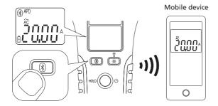
La FCC3450 intègre la technologie sans fil Bluetooth® v4.0 basse consommation pour transférer des données en temps réel. Pour utiliser une communication par liaison Bluetooth® sur les appareils Android ou iOS, installez l'application Megger Link™.
