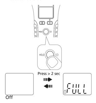
Appuyez sur le bouton marche/arrêt et maintenez-le enfoncé pendant plus de 2 secondes. Lors de la mise sous tension, l'écran indique l'autonomie actuelle de la batterie. La batterie doit être remplacée si une autonomie de 10 % ou moins est affichée, afin d'éviter des relevés erronés ou inexacts.
