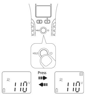
Le gel de l'affichage des valeurs peut être utilisé pour conserver les valeurs affichées, quelle que soit la gamme de mesure. Pour activer cette fonction, appuyez brièvement sur le bouton « Data Hold ». Pour revenir au mode de mesure normal, appuyez une deuxième fois sur le bouton « Data Hold ». H s'affiche à l'écran lorsque le gel de l'affichage des valeurs est actif.
