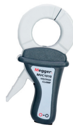
1010-518 MVC 1010 Stromzange (Öffnung 54 mm) zur Messung von Leck- und Ableitströmen von 0,1 mA bis max. 200 A. Als Messzange zur selektiven bzw. zur spießlosen Erdungsmessung
