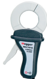
1010-516 MCC 1010 Stromzange (Öffnung: 54 mm) zur Induktion einer Spannung in eine geschlossene Leiterschleife. Anwendung zur spießlosen Erdungsmessung als induzierende Stromzange
