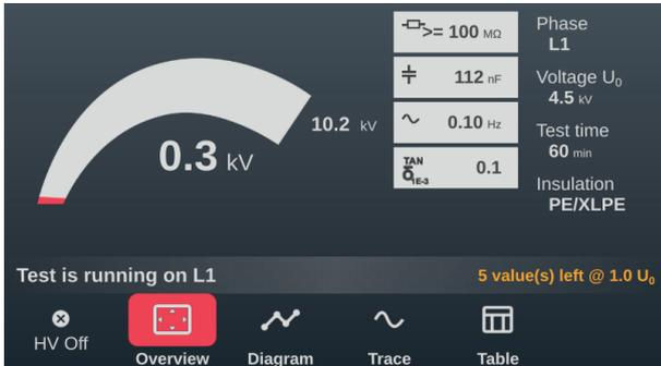
En complément aux indications de la tension de test et de la durée de test restante (ou des valeurs de mesures restantes lors d'un test de niveau), les valeurs de mesure suivantes s'affichent également :
