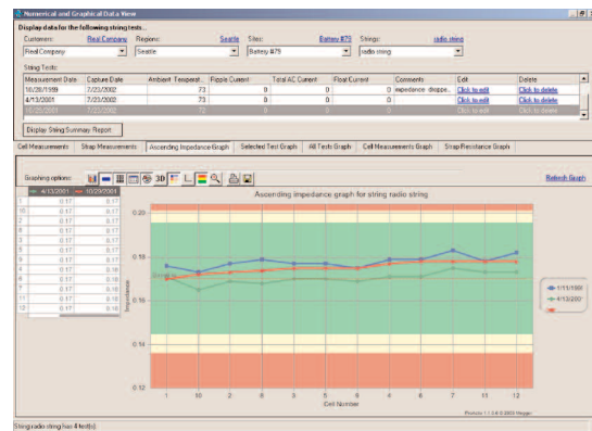
Figure 4 : Courbe représentant sur ProActiv la croissance de l'impédance et les zones «Bon», «Alarme» et «Mauvais»
