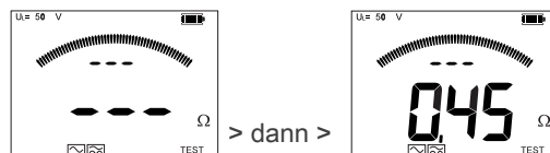
Abbildung 5. Startbildschirm für die Schleifenimpedanzmessung
