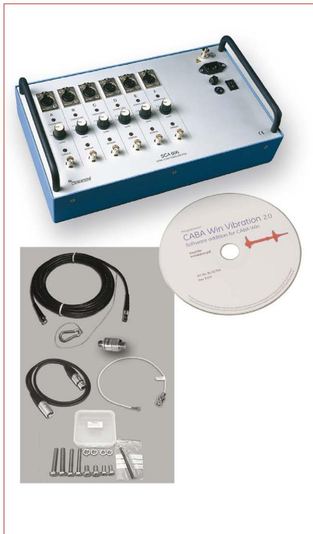
Kit vibratoire BL-13090 inclus : SCA606, logiciel CABA Win d'analyse vibratoire et 1 voie vibration.
