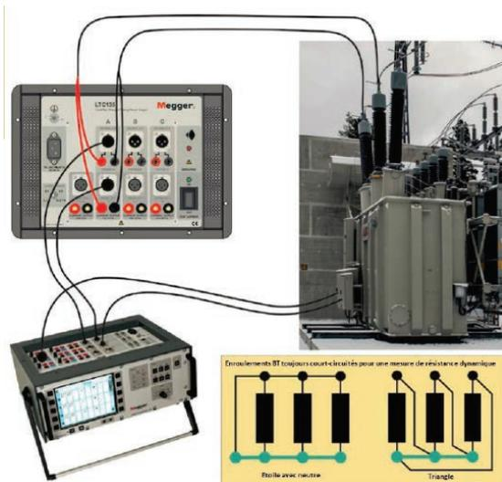
Exemple de raccordement sur un TM1760
