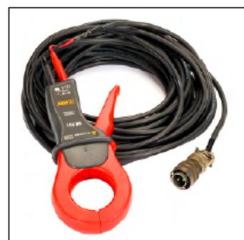
La sonde optionnelle C/N 37553, permet de mesurer les résistances de fuite sur les batteries de condensateur.
