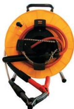
HSK 27B (version standard): Touret de câble HT de 25m, entraînement manuel, connexion : prises MC 10mm avec bornes HT et pince batterie : poids : env.17 kg
