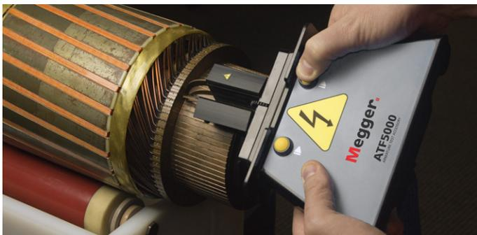
L'accessoire de test d'induit ATF5000 facilite et accélère les tests d'induits avec un grand nombre de bobines et de segments de collecteur
