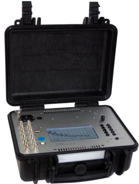
Les mesures de décharge partielle (DP) constituent une méthode non-destructive qui a fait la preuve de son efficacité pour l'évaluation de l'isolation électrique et qui permet d'éviter de coûteuses pannes non planifiées en détectant les problèmes à un stade précoce. L'ICMmonitor de Power Diagnostix est un détecteur de DP numérique non-invasif pour installation permanente qui assure la surveillance en continu de l'état d'une isolation moyenne ou haute tension.
