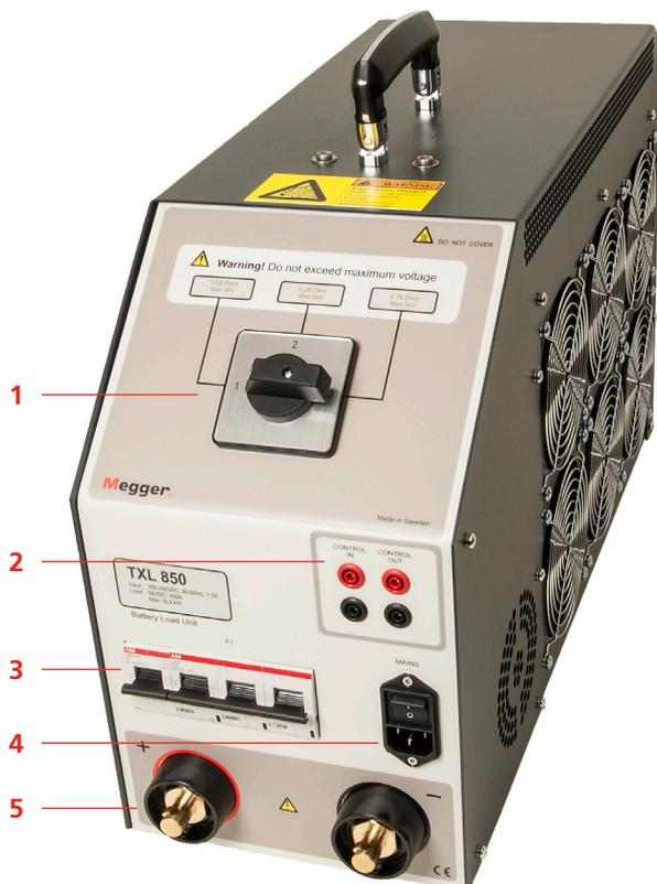
1. Sélecteur/Interrupteur utilisé pour régler la plage de tension souhaitée et/ou la valeur de résistance.
