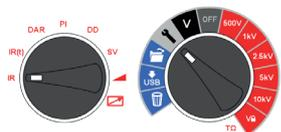
Pour régler la date et l'heure, placez le commutateur rotatif central sur Paramètres (symbole de la clé) et le commutateur de mode sur IR. Utilisez les flèches gauche/ droite pour positionner le curseur sur la date et l'heure.
