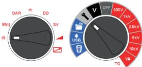
Pour régler la tension  $V_{\text{IR}}$ , sélectionnable par l'utilisateur et verrouillable, placez le commutateur rotatif central sur Paramètres et le commutateur de mode sur IR. La tension pré-réglée clignote et peut être modifiée au moyen des flèches haut et bas. Quand la tension maximale nécessaire s'affiche, appuyez sur le bouton OK pour sauvegarder le réglage. Ce réglage sera conservé jusqu'à ce qu'il soit réinitialisé.
