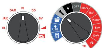
Les essais DAR et PI sont des mesures de la résistance dans le temps exprimées comme un rapport de la résistance au temps t2 divisée par la résistance au temps t1. L'hypothèse est que la température de l'isolation ne varie pas beaucoup pendant la durée de l'essai, de sorte que la valeur DAR et/ou PI qui en résulte est indépendante de la température. Les essais doivent être effectués à une température égale ou inférieure à 40 °C, 104 °F, pour que cette hypothèse se vérifie.
