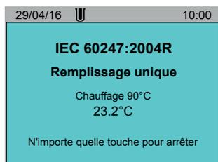
La cellule d'essai ne peut pas être manipulée sans danger (au-dessus de 50 °C)
