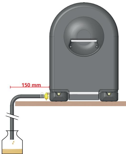
6. Si nécessaire, fixez un tuyau de débordement d'huile (non fourni (nécessite un adaptateur femelle BSP d'1/8 de pouce)). Veillez à brancher le tuyau sur un conteneur adéquat (ou placez-le dedans).
