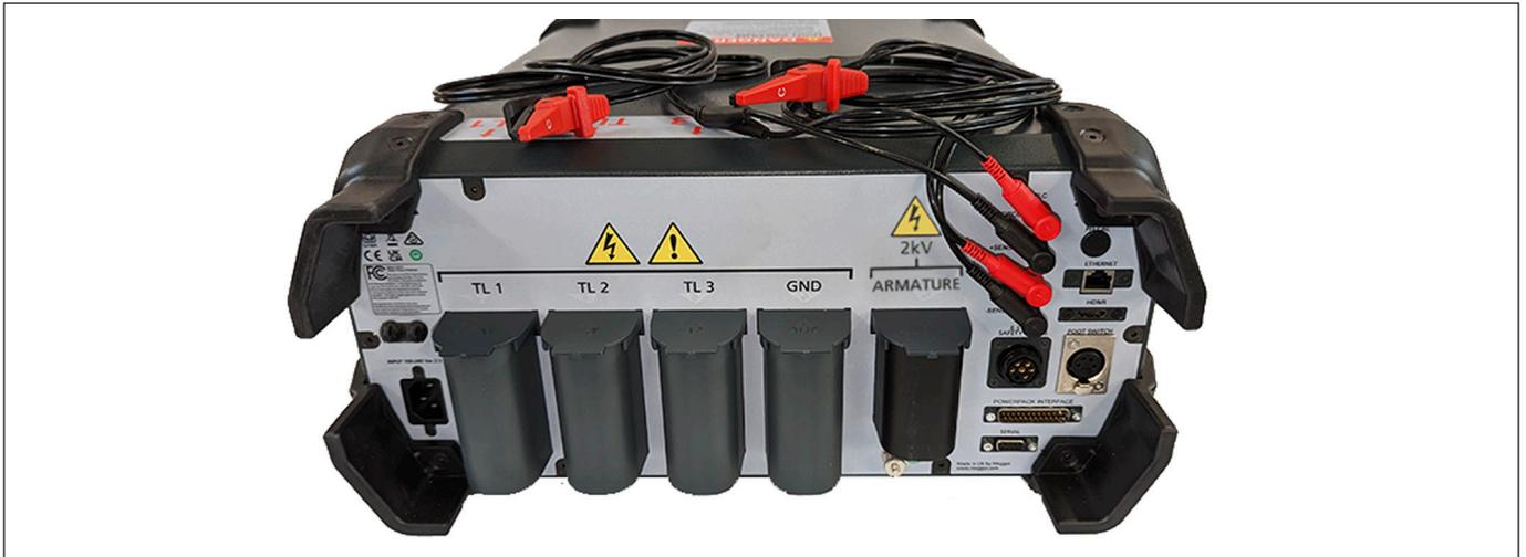
**Figure 131 :** Connecteurs RLC avec jeu de clips.
