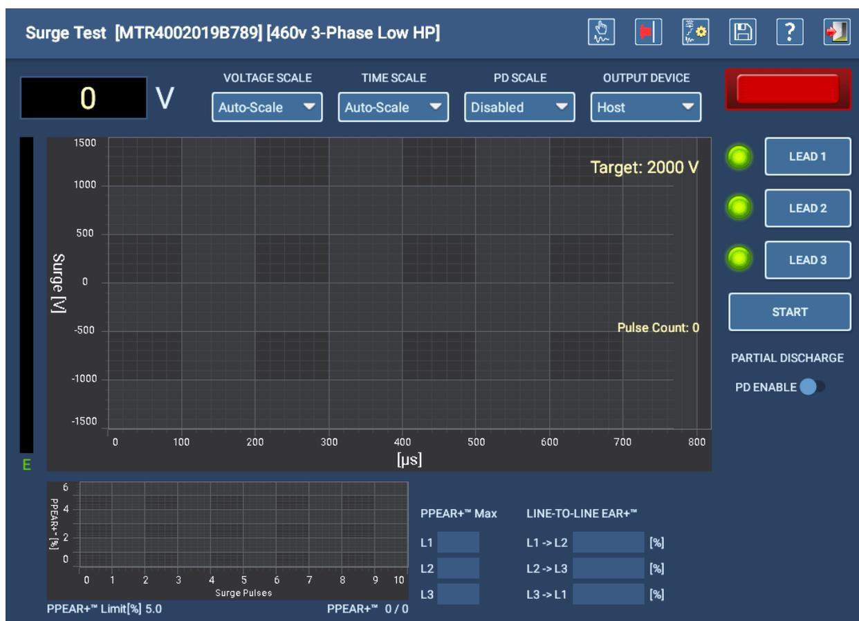
Figure 110 : Écran Test de surtension automatique : Démarrer.
