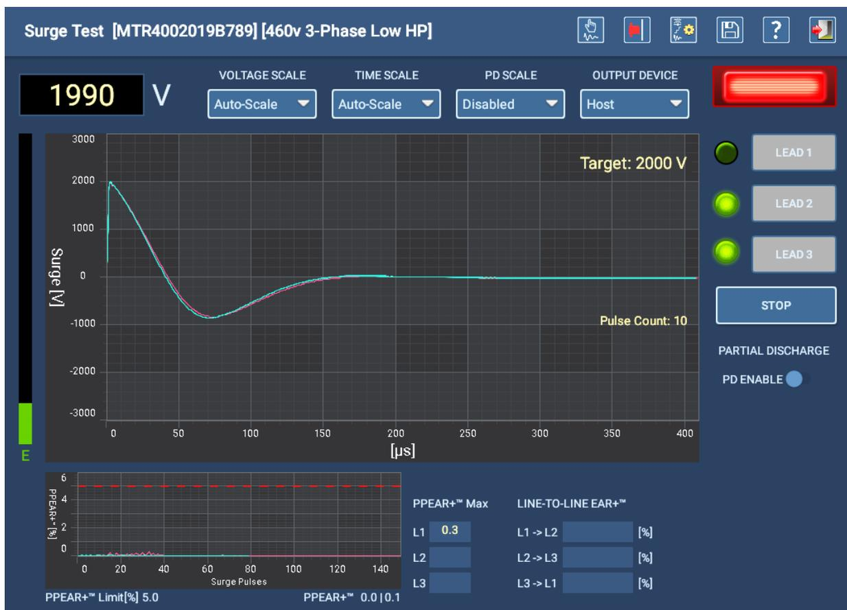
Figure 125 : Écran Test de surtension automatique.
