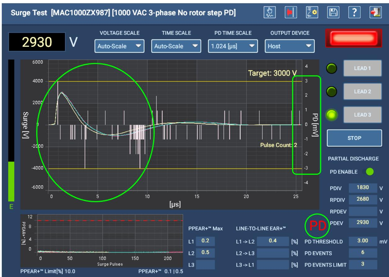
Figure 113 : Écran Test de surtension de l'ADX avec DP activé et valeurs enregistrées.
