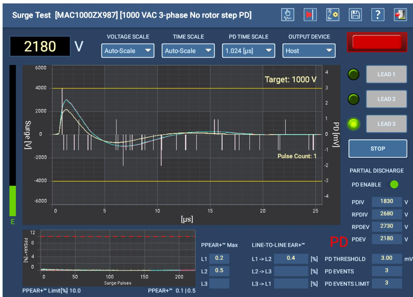
Figure 114 : Chute de tension jusqu'à la cible de décélération (1 000 V ici), capture des valeurs d'extinction pour le cordon 3.
