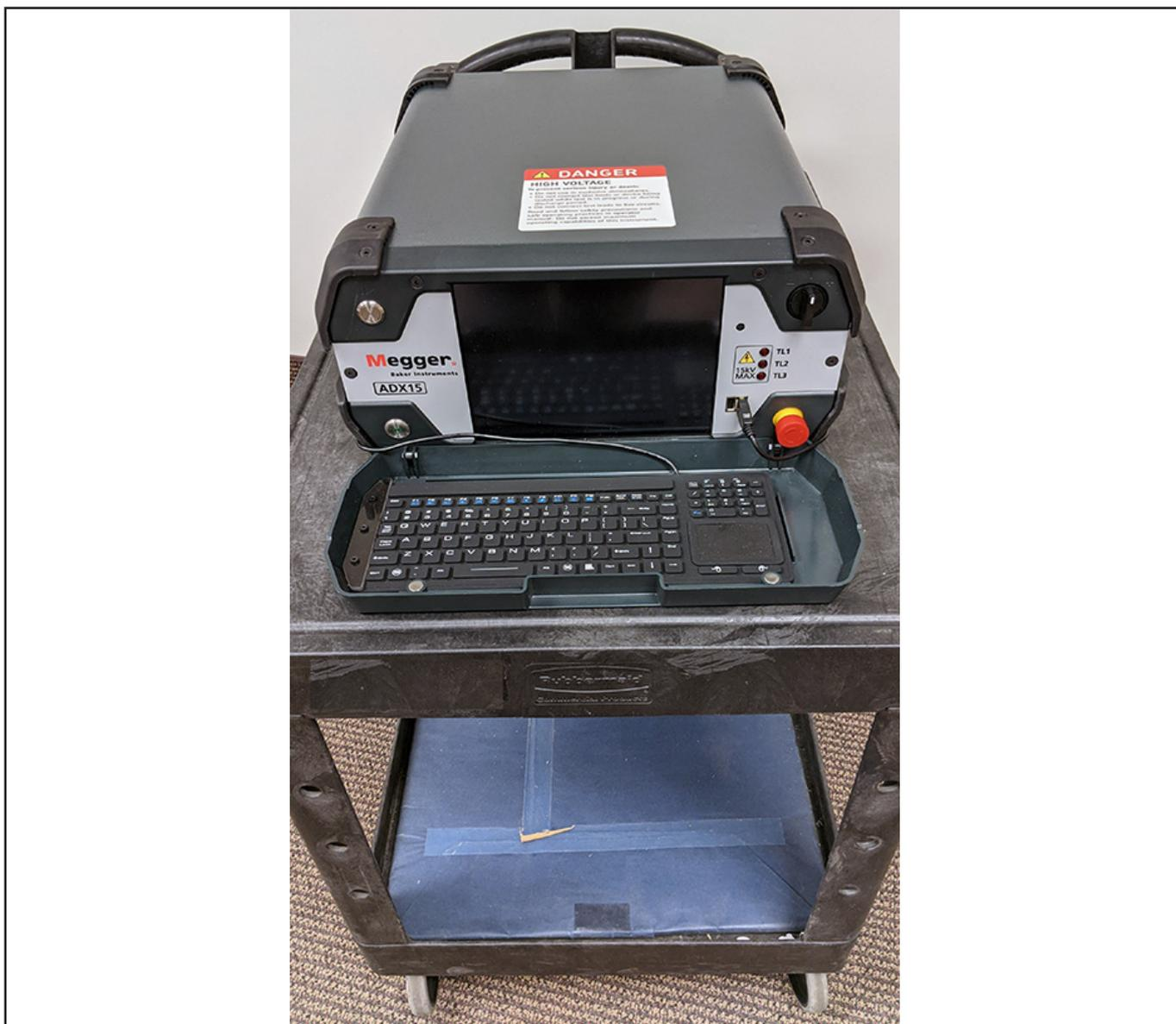
**Figure 20 :** ADX reposant sur le chariot de travail ; toutes les butées inférieures sont en contact complet ; roues bloquées.
