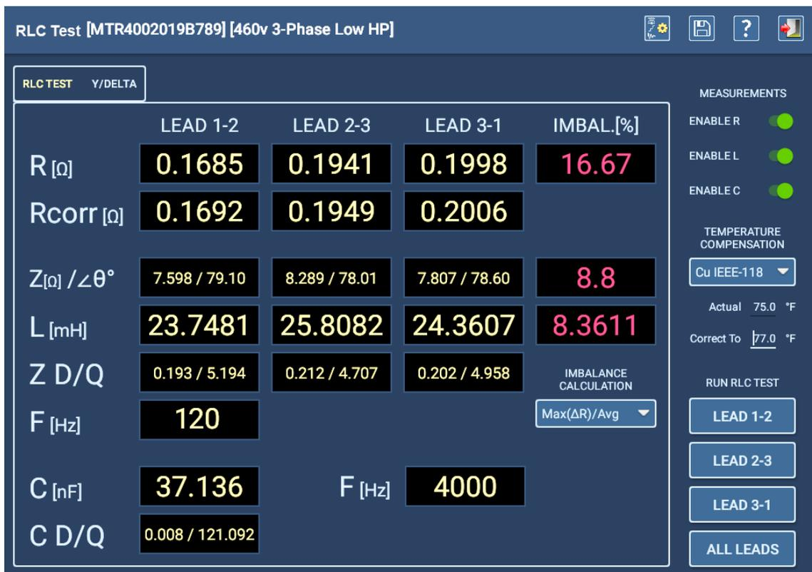
Figure 81 : Test manuel : onglet résultats du test principal RLC.
