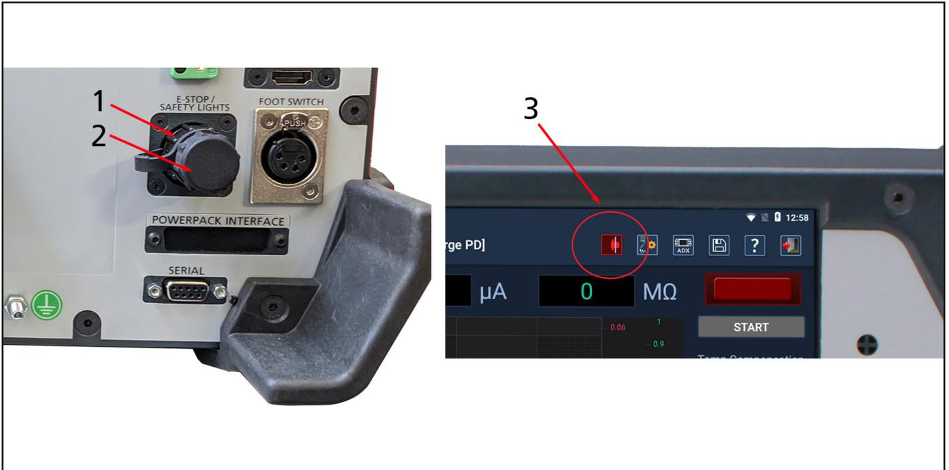
**Figure 7 :** Connecteur et couvercle pour cavalier d'arrêt d'équipement (à gauche). Indicateur d'arrêt de l'équipement dans la barre d'outils de l'écran de test ADX (à droite).
