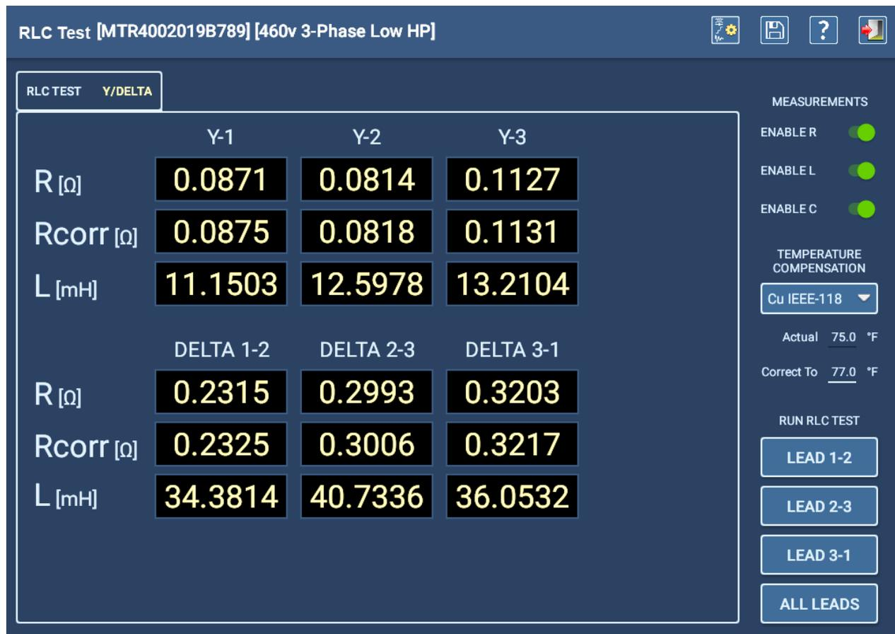
Figure 82 : Test manuel : onglet RLC Étoile/Triangle.
