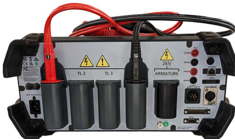
Figure 3 : Inspectez les prises et les câbles des cordons de test avant chaque utilisation.
