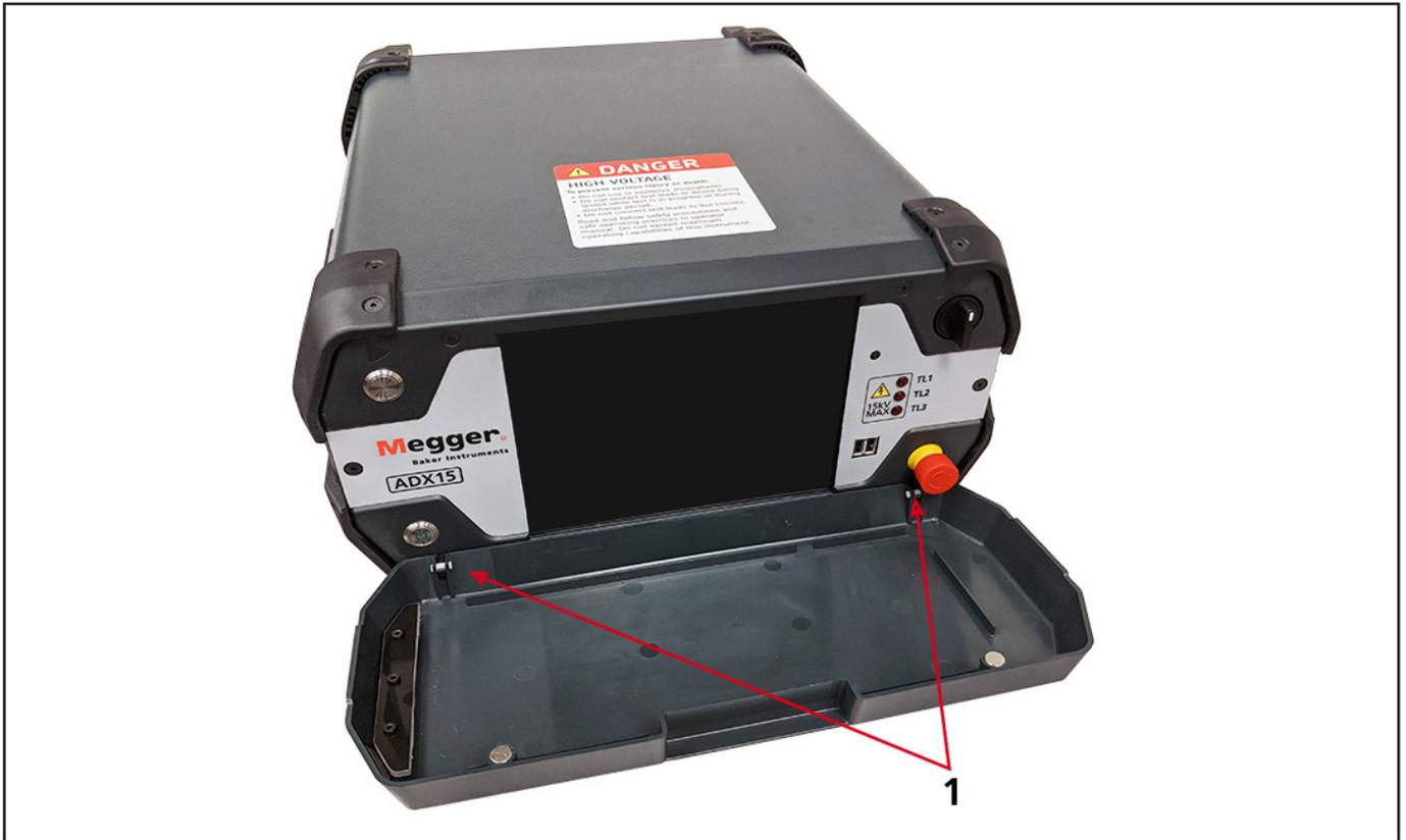
**Figure 21 :** Repérez les broches de charnière avant de retirer le plateau du clavier.
