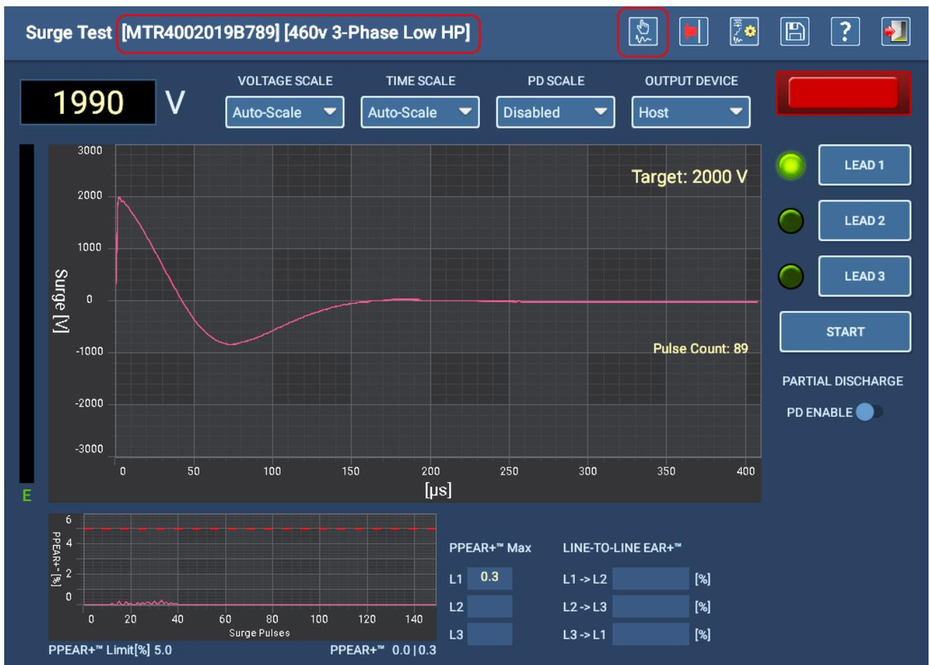
**Figure 89 :** Acquisition de la forme d'onde de référence pour le test de surtension sur le CORDON 1.
