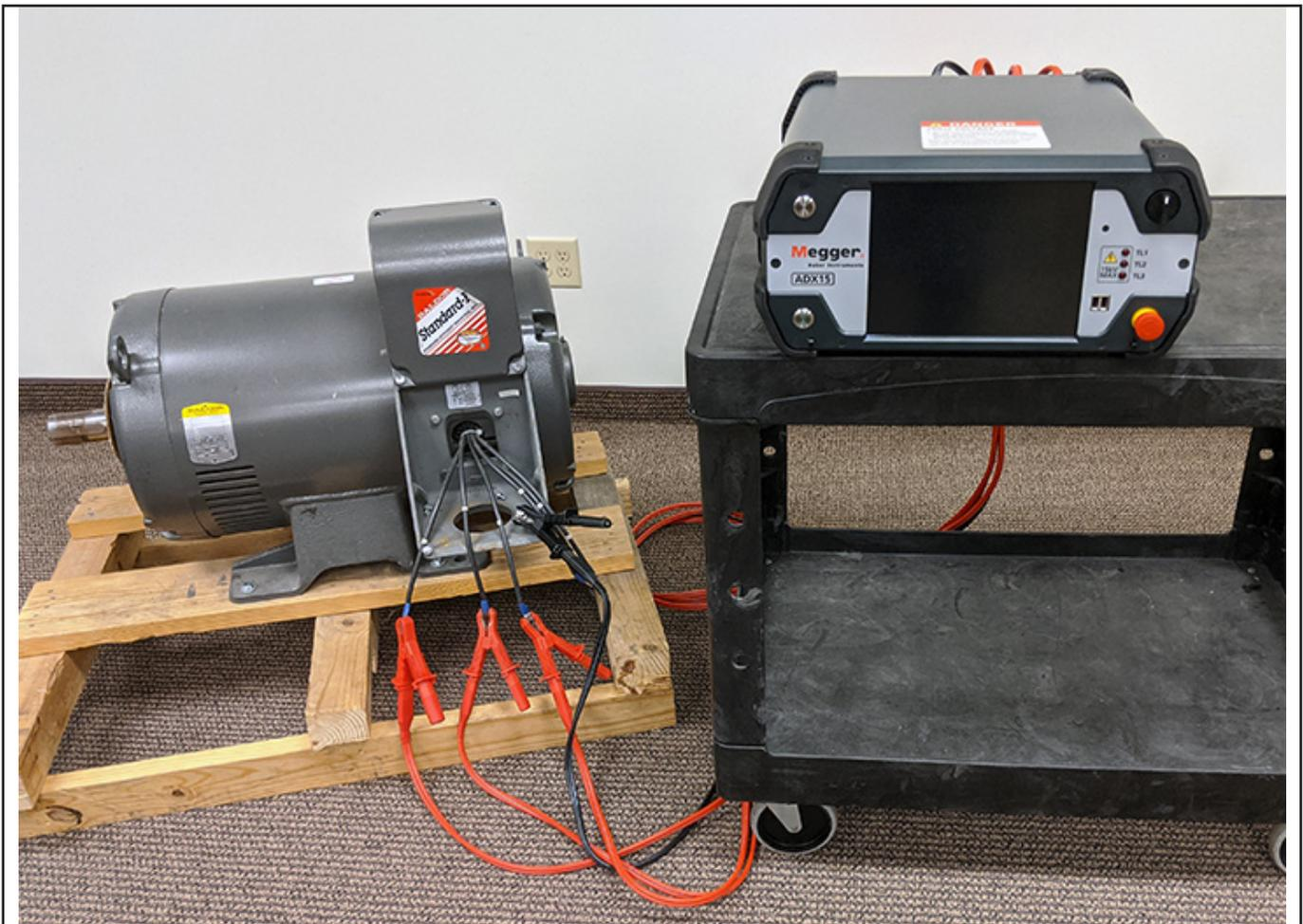
**Figure 28 :** *Veillez à ce que les cordons de test de l'ADX et les câbles de l'actif testé soient correctement séparés et positionnés.*
