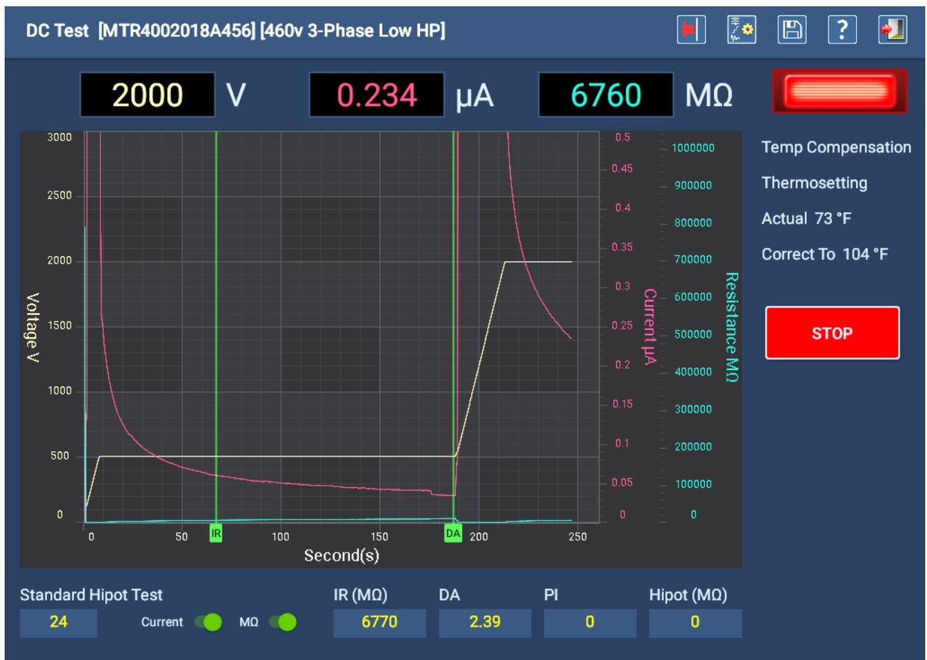
Figure 124 : Écran Test CC automatique : test en cours.
