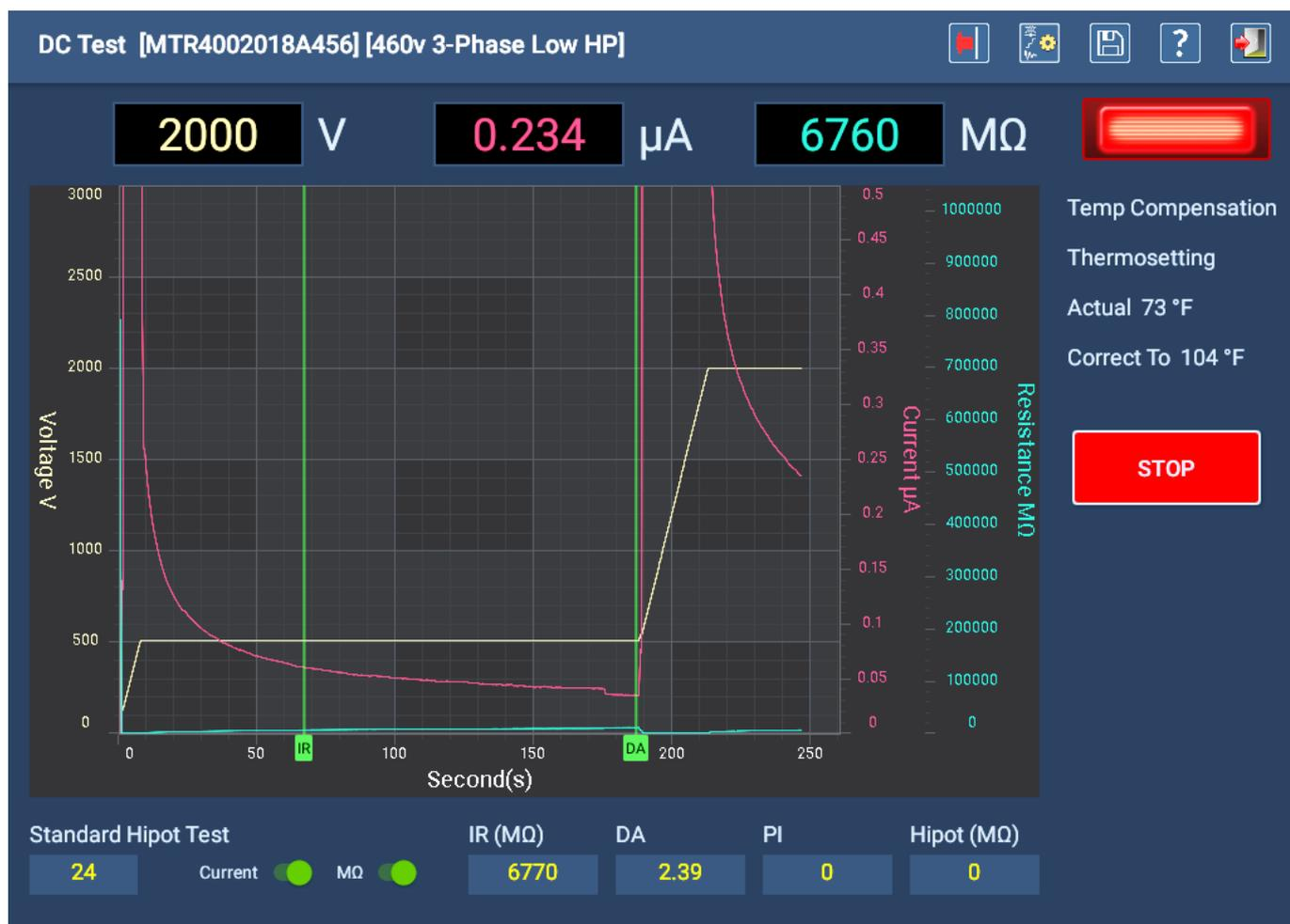
Figure 108 : Écran Test CC automatique exécutant le test HiPot standard.
