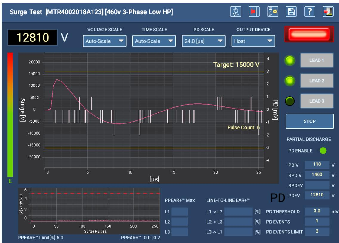
Figure 119 : Barre d'énergie de surtension indiquant l'énergie maximale atteinte.
