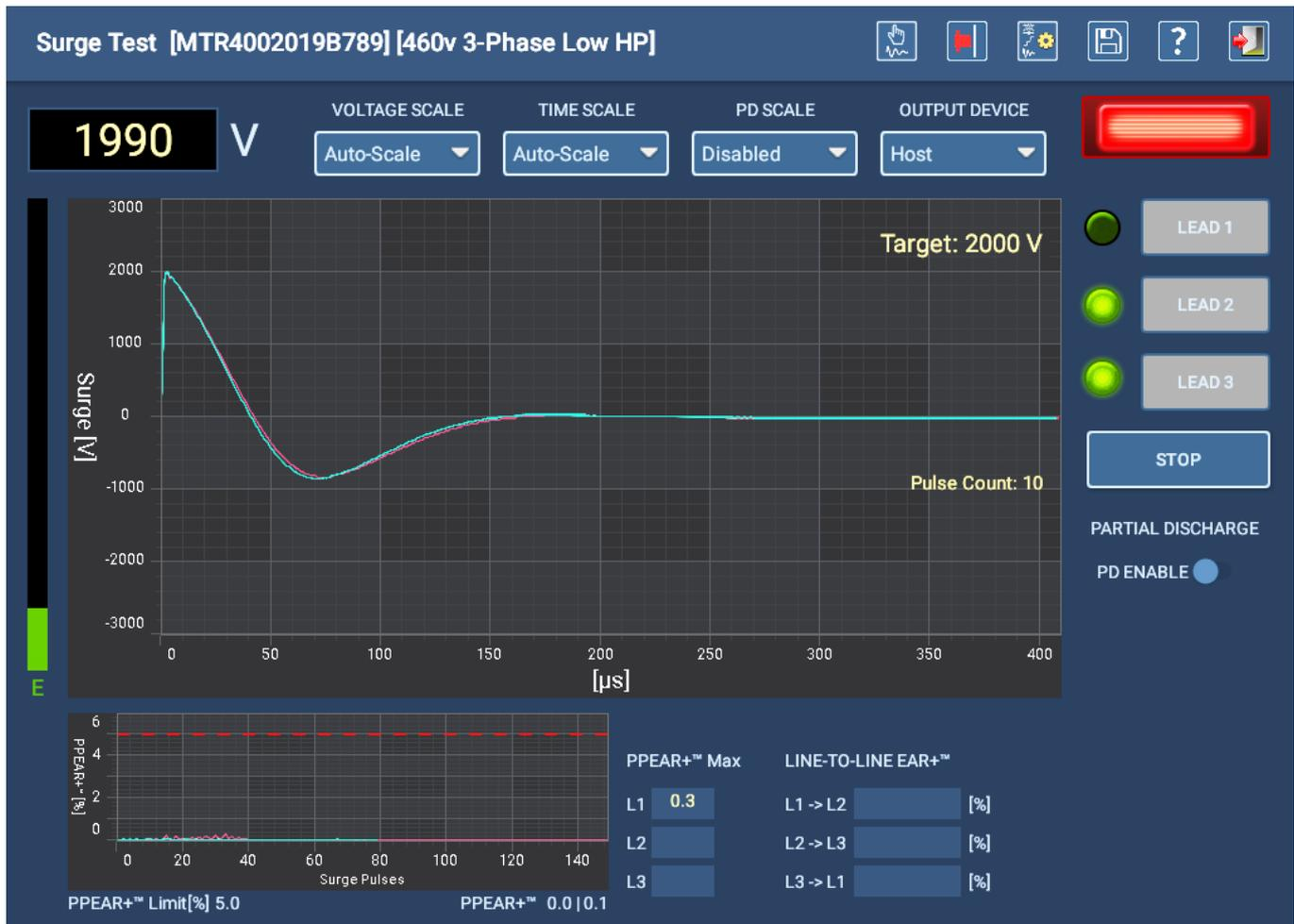
Figure 111 : Écran Test de surtension automatique : test en cours.
