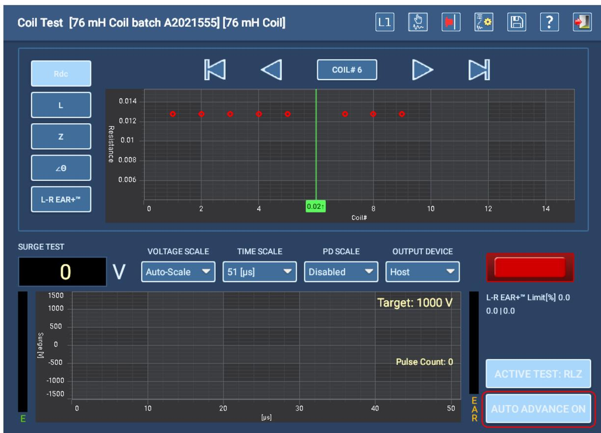
Figure 100 : Écran Test de bobine avec exemple de test RLZ en cours.
