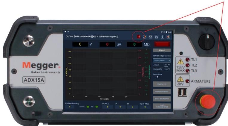
Figure 2 : Bouton d'arrêt de l'équipement du testeur ADX de Megger Baker.
