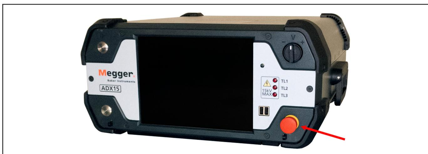
**Figure 145 :** Megger Baker ADX montrant le bouton d'arrêt de l'équipement.
