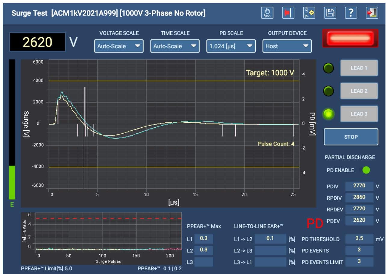
Figure 118 : Test de surtension avec DP en Mode automatique pour confirmer les paramètres.
