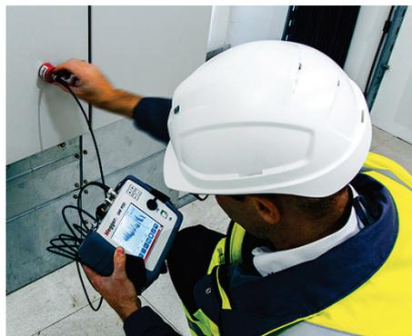
Le HFCT SC40 et le HFCT 20 sont deux capteurs HFCT dans le choix des accessoires (voir page 11) de Megger qui sont parfaitement assortis à l'appareil et adaptés pour une utilisation en extérieur dans le cadre de la mesure des décharges partielles des câbles et de leurs composants. Ils s'installent sur les écrans de terre des extrémités des câbles.
