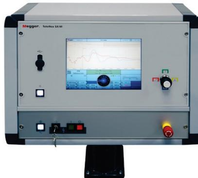
Pour désactiver la haute tension, il est également possible d'utiliser à tout moment, lors du fonctionnement haute tension, la touche logicielle **HV OFF** équivalente au bouton « HT OFF ».
