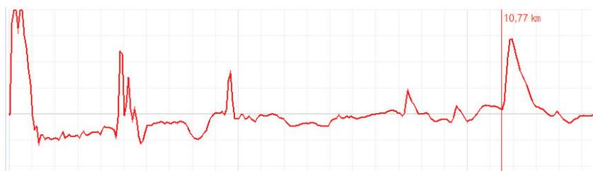
A l'aide du mode de fonctionnement spécial  $\frac{IFL}{INT}$ , il est également possible de localiser des défauts de câble sporadiques et de faible impédance (qui varient dans le temps) (qui peuvent par exemple être dus à des vibrations de circulation).
